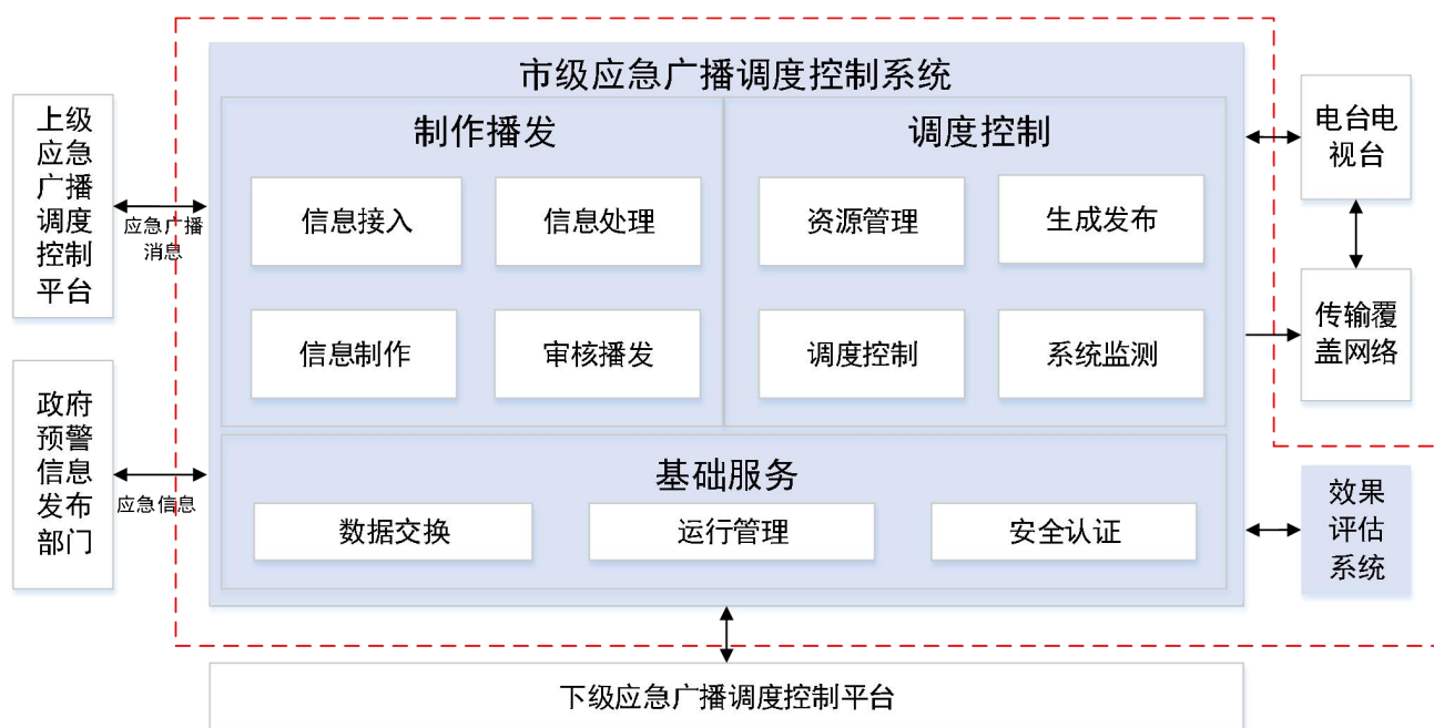
图 3-3 市级应急广播调度控制平台基本架构
